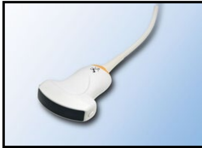
Figure 3 : Sonde Monocrystal XC6-1 utilisée pour les essais in-vitro et in-vivo et détail des séquences d'imagerie US ultrarapides développées pour le projet
